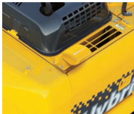
Telecamera supplementare, visione sul lato destro della macchina (optional)
